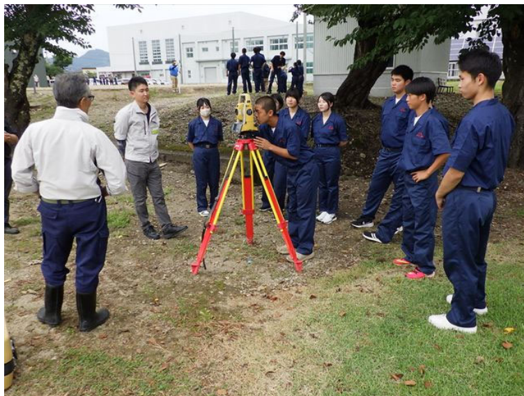
自動追尾トータルステーション による計測
